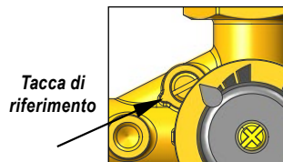
Il by-pass è completamente aperto e consente il massimo ricircolo. Il taglio a cacciavite si trova allineato alla tacca di riferimento.
